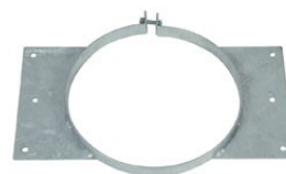
Abb. oben: Schachtaufleger (links) zur Befestigung des Schachtrohrs Wichtig: Je Geschossdecke wird ein Schachtaufleger benötigt! Teleskop-Wandhalterung zur zusätzlichen Fixierung von Schachtrohren bzw. Halterung des Endrohrs im Auswurfbereich!
